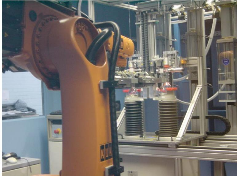
Das Bild zeigt eine vollautomatische Anlage – Speed Aquajust – zur Kalibrierung von Messkolben.
