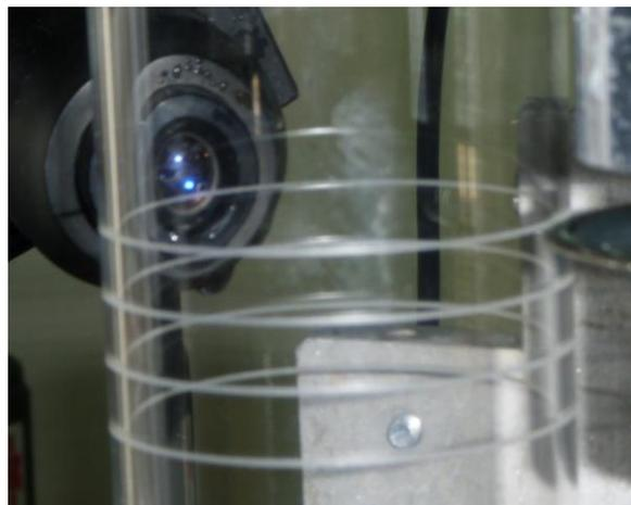
Kraftgesteuertes Schleifen von Glas mit optischer Überwachung.
